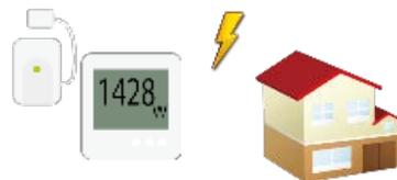
測定機器を貸し出し分電盤に取り付けます。計測期間は最短で1ヶ月です。
